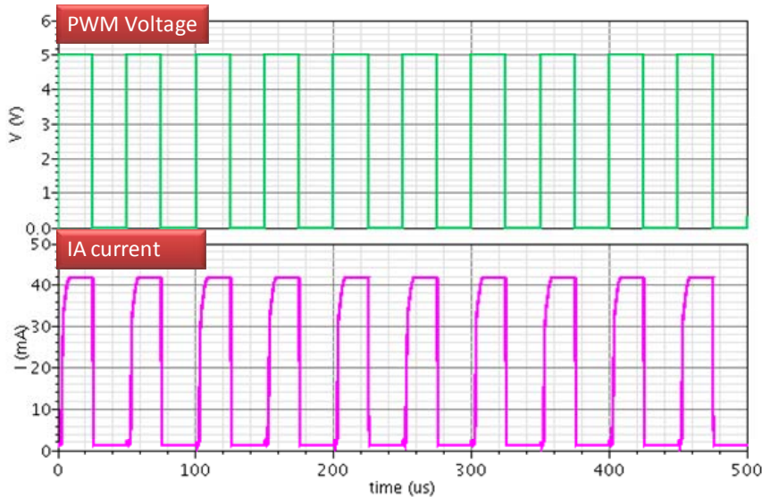
图 10: PWM 及输出电流
